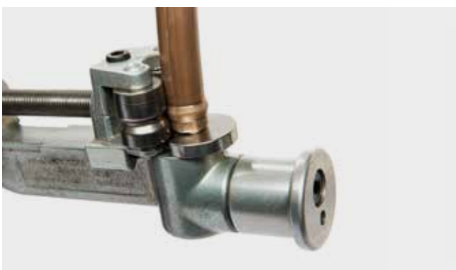
Bild 5 Rohrende schmieren und Sickenpresse mit leicht angestelltem Druck drehen
