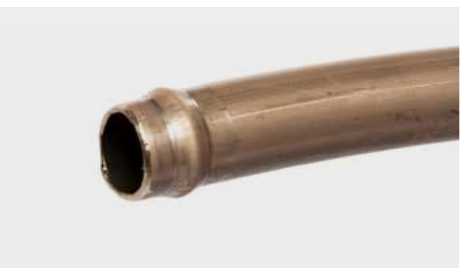
Bild 6 Für wiederholgenaue Sicken Presstiefe mit Anschlagmuttern begrenzen
