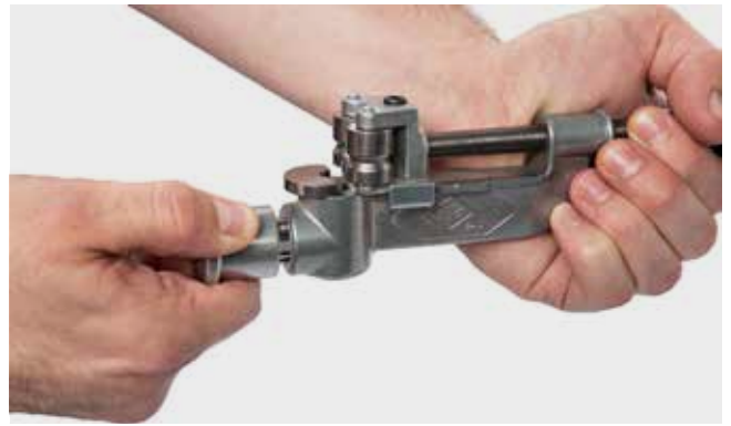
Bild 2 Verschlussknopf ziehen für Matrizenwechsel
