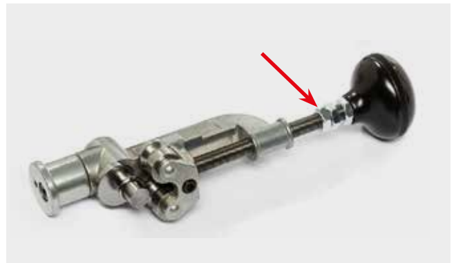
Bild 6 Für wiederholgenaue Sicken Presstiefe mit Anschlagmuttern begrenzen
