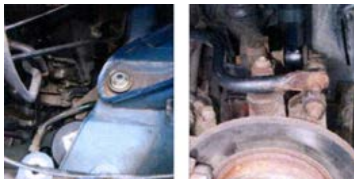
Abbildung 19-20: Das obere Mutterndrehmoment beträgt 50Nm, den hinteren Stabilisator wieder anschließen, Drehmoment 45Nm.
