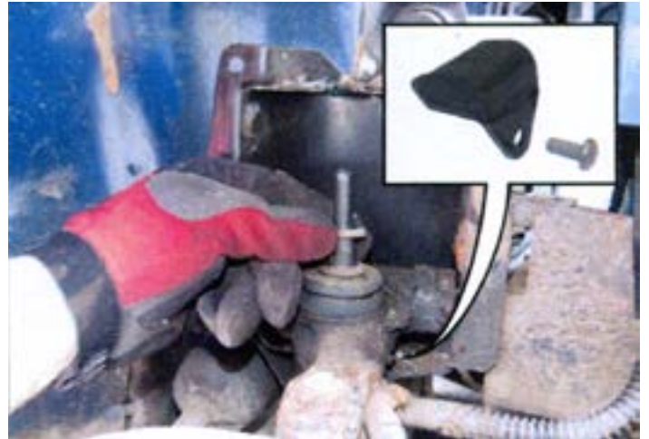
Abbildung 8: Halten Sie die Distanzscheibe fest.
