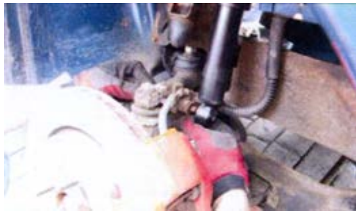
Abbildung 12: Montieren der unteren Dämpferschraube.
