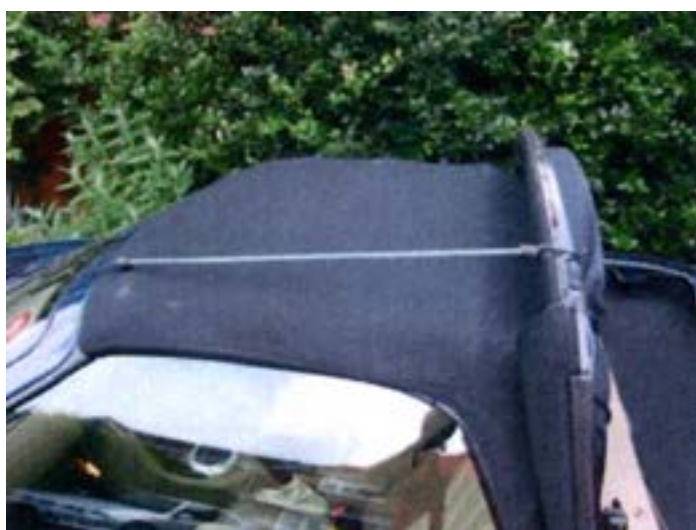
Abbildung 24: Holm in Position halten.
