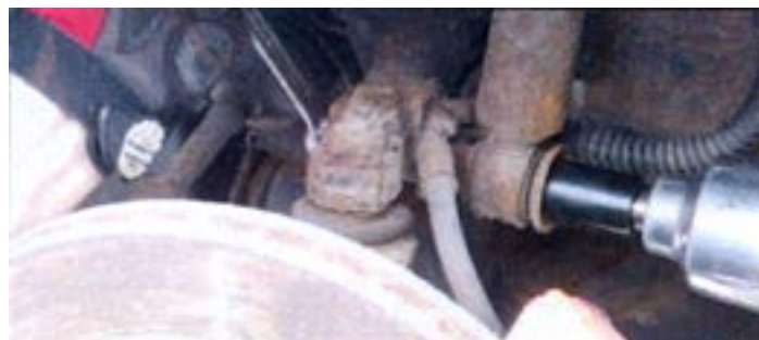
Abbildung 3: Beachten Sie die korrekten Positionen von Bremsschlauchschelle, Abstandshalter und zwei Unterlegscheiben.
