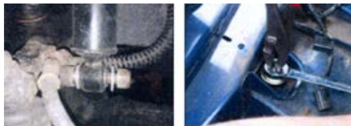
Abbildung 13-14: Komponentenordnung wie dargestellt - Welle mit der Zange halten, während die obere Mutter angezogen ist.
