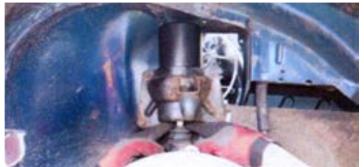
Abbildung 9: Verriegeln Sie die neue Einheit an ihrem Platz.
