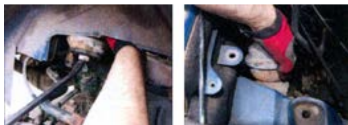
Abbildung 17-18: Heben Sie das Hydralastic-Element durch den Motorraum und nicht durch den Radkasten heraus.
