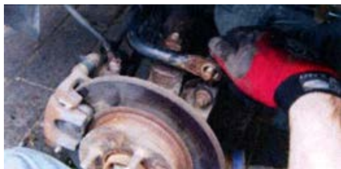
Abbildung 16: Lösen und entfernen Sie den Stabilisator, um die obere Mutter und die Schraube zu verbinden.
